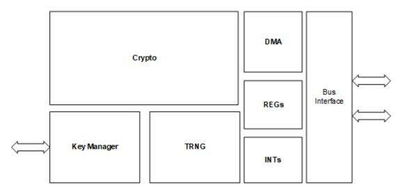
Figure 17. Crypto Subsystem
