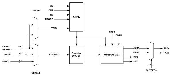
Figure 13. TIMER Block Diagram
