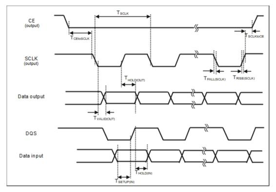
Figure 63. MSPI1/MSPI2 DDR with DQS Mode Timing Diagram
