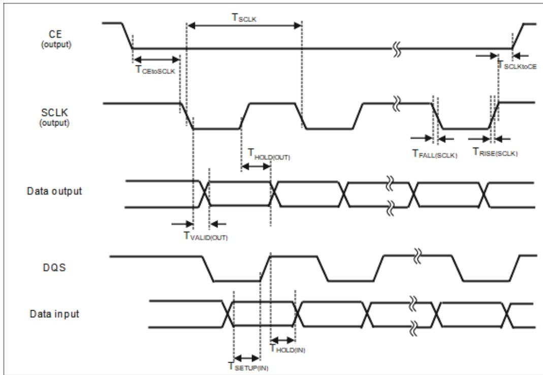
Figure 63. MSP11/MSP12 DDR with DQS Mode Timing Diagram
