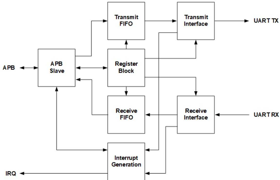
Figure 30. UART Block Diagram
