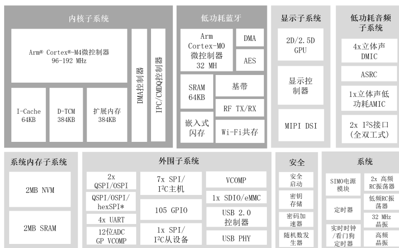
超低功耗Apollo4 Blue Plus SoC的框图
